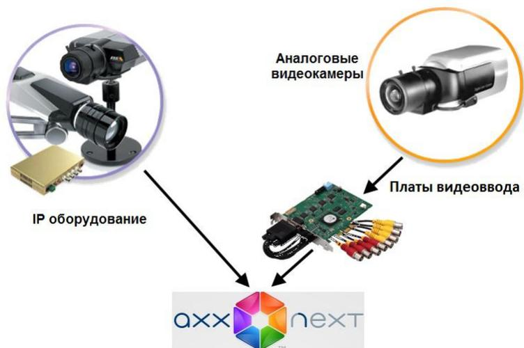
Рис. 1.3—1 Гибридная система безопасности на базе ПК *Axxon Next*
