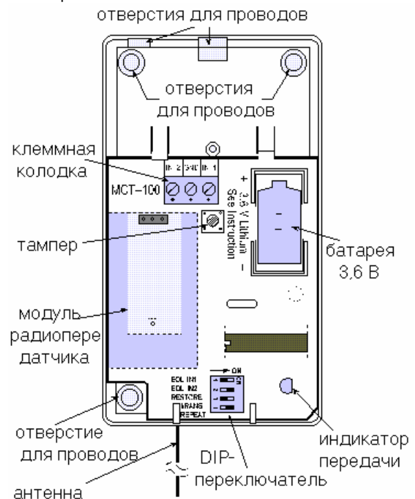
Рисунок 1. МСТ-100 со снятой крышкой
