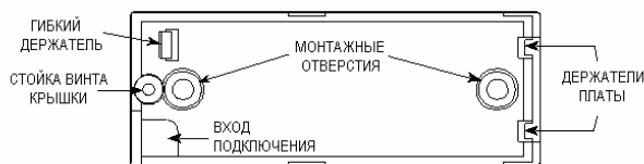
Рисунок 5. Основание со снятой печатной платой
