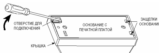
Рисунок 4. Снятие крышки с основания
