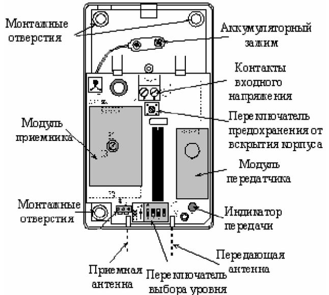
**Рисунок 5.** MCX-600 со снятой крышкой.
